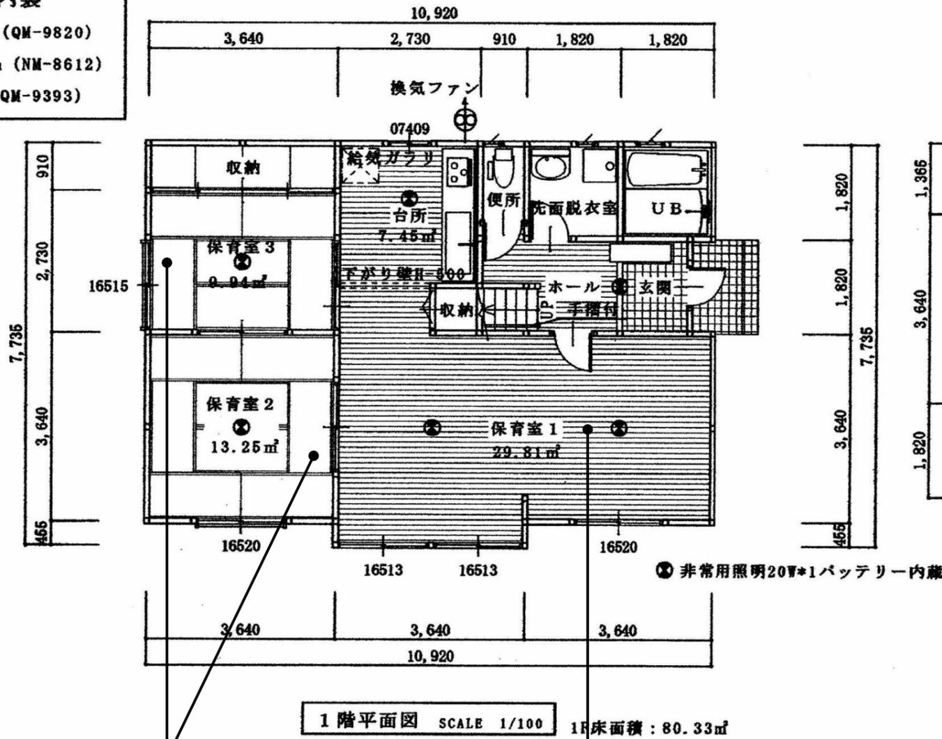
1階平面図 SCALE 1/100 1F床面積 : 80.33㎡
