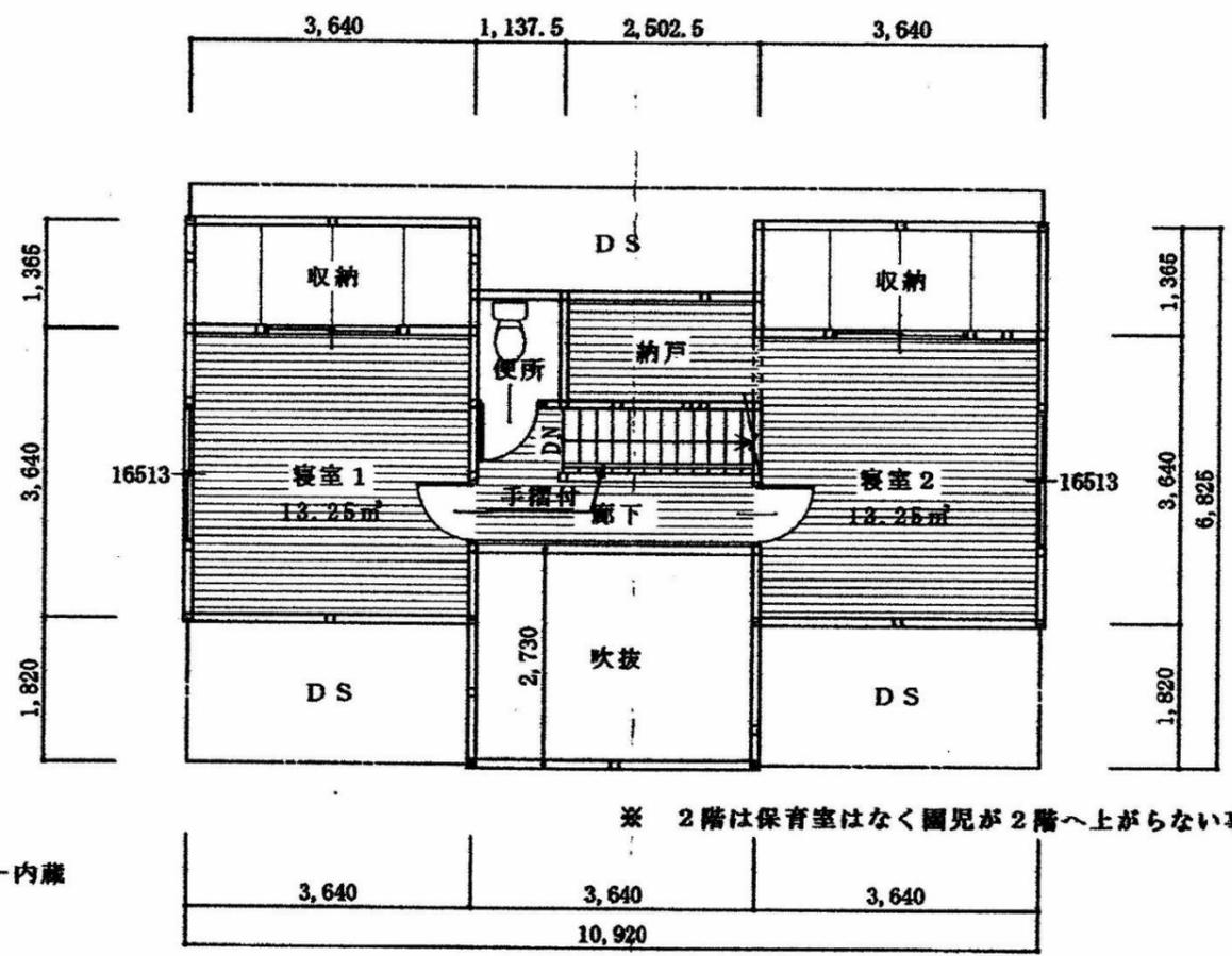
2階平面図 SCALE 1/100 2F床面積 : 48.03㎡
