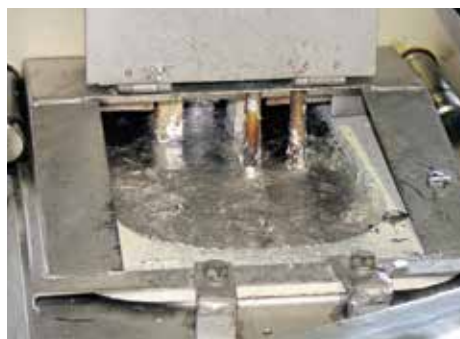
ダイカスト炉内の溶解中の亜鉛
