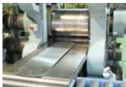
スパッタリングターゲット材料の製造用の厚板用圧延機
