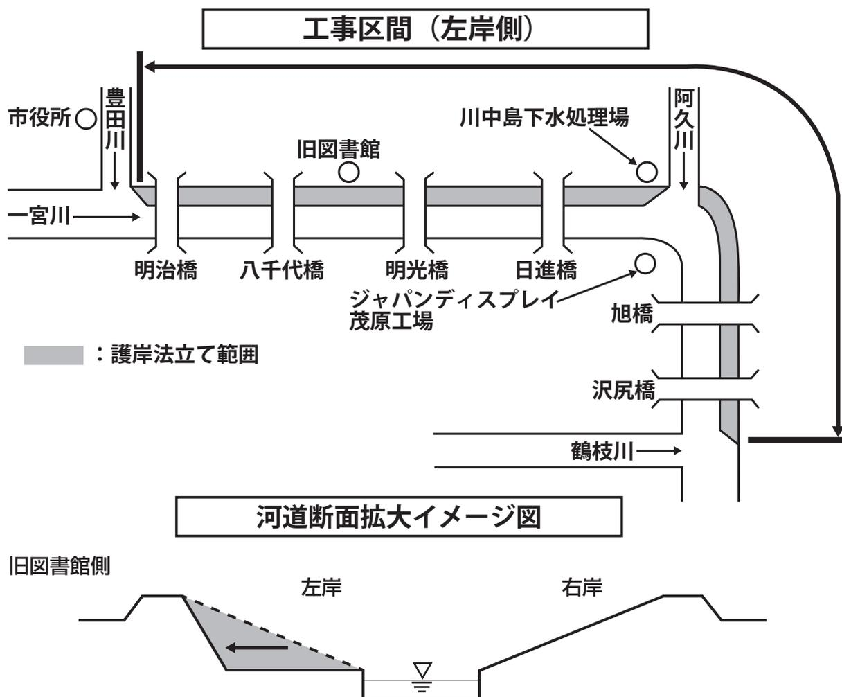
護岸の勾配を急にして、川の水を流す断面を大きくします。
