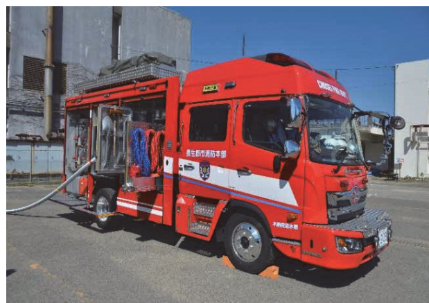
▶ 配備された水槽付消防ポンプ自動車
