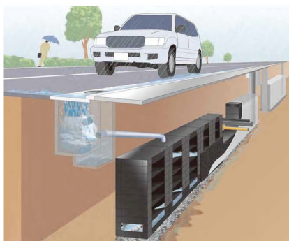
図 5-7 雨水流出抑制施設のイメージ（公財日本下水道新技術機構資料より）
