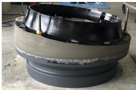
図 4-1-1 傾斜施工試験状況
