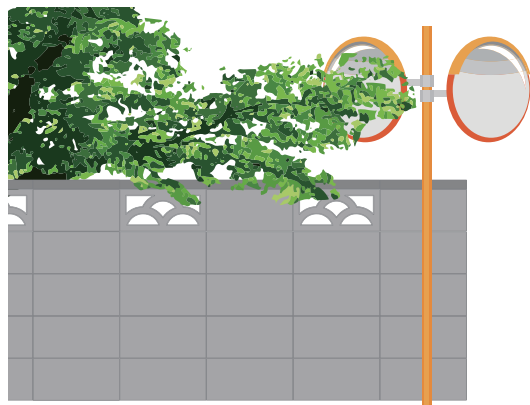
張り出した枝により見えづらくなったカーブミラー
